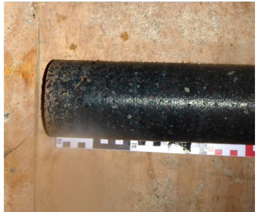
Bild 5: Kernbohrung durch Wandquerschnitt (im hellblauen Bereich in Bild 4); die angeschnittenen Stahlfasern im Bohrloch nahe der Wandoberfläche sind gut erkennbar
