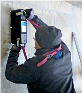
Bild 1: Einsatz und Messprinzip eines multistatischen Ultraschallarrays; beschleunigte Messdatenaufnahme durch Mehrfachanordnung von Sendern und Empfängern
