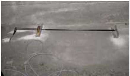
Bild 6: IWA mit 50 cm Messbasis mittels Verlängerungsstab aus Carbon Foto: Nico Steffens
