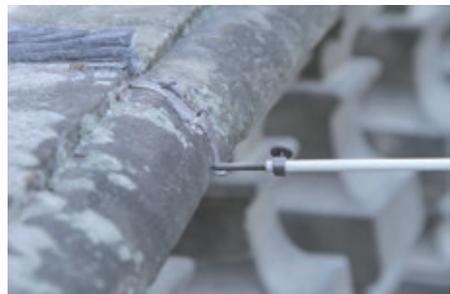
Bild 7: Wegaufnehmer zur Erfassung von Verformungen des Handlaufs Foto: Sabine Wellner
